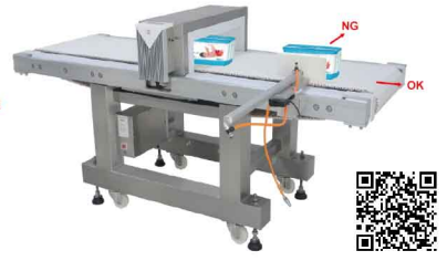
載重型金檢機(大型包裝)-40KG +推排
